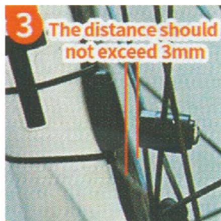
3. Vyrovnání hlavy mezi dvěma snímači nesmí být větší než 3 mm
