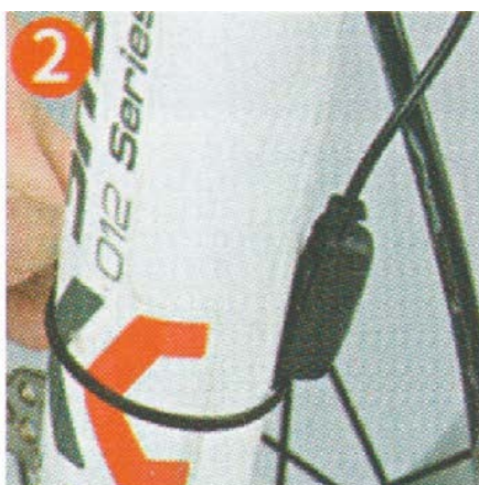
2. Nainstalujte induktor na přední vidlici naproti kotoučové brzdě.
